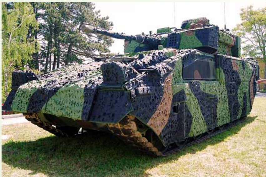
Optimierter SPz ULAN bei der Erprobung des Mobile Camouflage Systems
