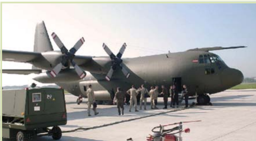
Technische Daten C-130 „Hercules“: Triebwerke: 4 Rolls-Royce T56-A-15 Turbo-Prop.-Triebwerke, Turbinenleistung: 4 x 4.508 Wellen-PS, Länge: 29,79 m, Höhe: 11,66 m, Spannweite: 40,41m, Reisegeschwindigkeit: 540 km/h, Höchstgeschwindigkeit: 603 km/h, Reichweite: Zwischen 3.000 km (ca. 18 t Nutzlast) und 6.000 km (ca. 10 t Nutzlast), max. Abflugmasse: 70.307 kg, max. Nutzlast: 19.369 kg oder 92 Passagiere oder 64 Fallschirmspringer oder 74 Tragbahnen + 2 Sanitäter
