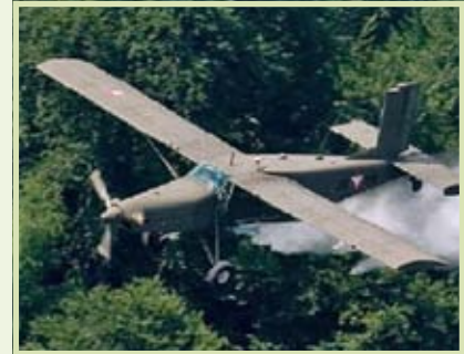
Technische Daten Pilatus PC-6 „Turbo Porter“: Triebwerke: Pratt & Whitney PT 6A-27, Turbinenleistung: 410 kW (550 PS), Länge: 11,00 m, Höhe: 3,20 m, Spannweite: 15,20 m, Kraftstoffverbrauch: 150 l/h (in 3.000 m Höhe), Reisegeschwindigkeit: 225 km/h, Höchstgeschwindigkeit: ca. 300 km/h, Reichweite: 1.000 km (in 3.000 m Höhe), Dienstgipfelhöhe: 8.100 m, max. Abflugmasse: 2.760 kg, Sanitätsversion: 2 Krankenträger + 2 Personen
