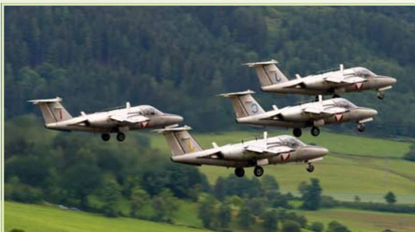
Technische Daten Saab 205 OE: Triebwerke: 2 Strahltriebwerke General Electric J85 17B, Turbinenleistung: 2 x 1290 kp Schub, Länge: 10,80 m, Höhe: 2,70 m, Spannweite: 9,50 m, Reisegeschwindigkeit: 680 km/h, Höchstgeschwindigkeit: 970 km/h, Einsatzradius: ca. 850 km, Dienstgipfelhöhe: 13700 m, max. Ablugmasse: 5700 kg, Bewaffnung: 2x 30mm Maschinenkanone (in Kanonenbehältern) und ungelenkte Raketen, 75mm
